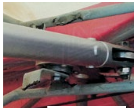
Ulomené uchycení páky ovládání křidélek
