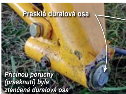
Důsledek nevhodné konstrukce úpravy podvozku – kola jsou jinde...
