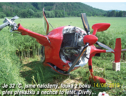
Následek neuvolněné parkovací brzdy a pozdního rozhodnutí
